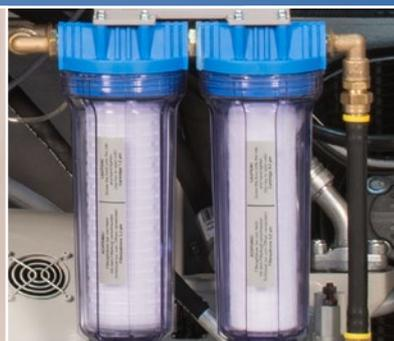
Optimales Speisewasser durch die Doppelfiltereinheit mit 5 und 1,2 µm.
