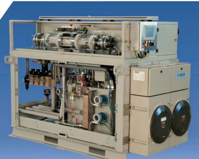
**PEROXID DOSIERPUMPEN** mit Druckübersetzer in „Single“ und „Stand-by“ Ausführung, Druckbereich bis 350 MPa, Fördermengen bis 150 l/h, sowie Hochdruck-Rohrleitungssysteme und Einspritzdüsen für den Einsatz in LDPE (Low Density Polyethylene) EVA (Ethylene Vinyl Atzetat) Reaktoren.
