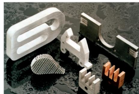
Technische Bauteile, geschnitten mit dem Wasserabstrahlstrahl.
