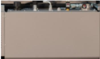
Der Öltank der ECOTRON® ist aus Aluminium hergestellt um Rost durch Schwitzwasser zu verhindern. Öltemperatur und Ölniveau ist auf den Instrumenten direkt auf dem Öltank ablesbar
