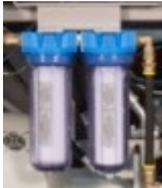
Eine doppelte Filtereinheit mit Einsätzen von 5 und 1.2 µm ist Standard, um ein Eindringen von harten Verschmutzungen in den Hochdruckübersetzer zu vermeiden. Das verhindert Schäden an Dichtungen und Ventilen.
