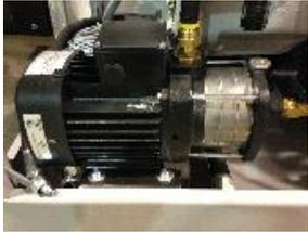
Die Vordruckpumpe ist notwendig, wenn der Frischwasserdruck unter die geforderten 3 bar fällt. Ist der Füllwasserdruck zu niedrig, können Luftblasen in den Hochdruckübersetzer kommen. Werden diese nun auf 400 Mpa verdichtet, entsteht große Hitze welche die Dichtungen und Komponenten schädigen. Eine Vordruckpumpe kann die Lebensdauer der Hochdruckkomponenten verlängern.
